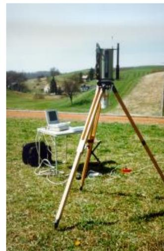
Рис.5 Полевой гамма-спектрометр
